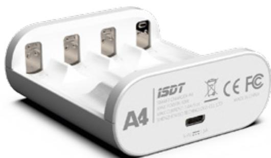
Der iSDT Smart Charger A4 ist ein Ladegerät für Einzelzellen AAA (Micro), AA (Mignon) oder Li-Ion 12500. Es können 1-4 Akkus zugleich geladen werden. Dabei kann der Akku Typ unterschiedlich sein.
