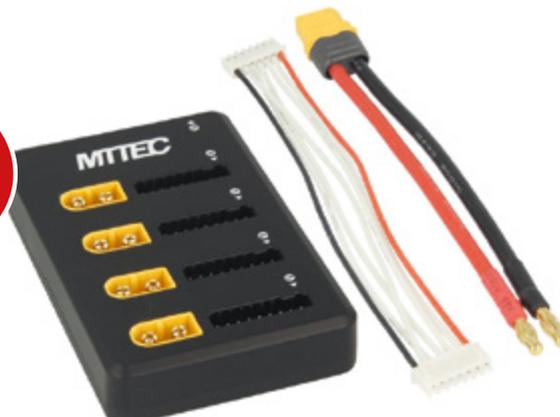
Parallel Ladeboard für bis zu 4 Lipo-akku Packs mit bis zu 8 Zellen, 4 Anschlüsse für je 2-8S Lipoakkus Packs XHR Balancersteckersystem, 4 Anschlüsse XT60 Stecker, 3 Hauptsicherungen zur Absicherung der Ladeanschlüsse untereinander, 24 SMD Sicherungen zur Absicherung der Balanceranschlüsse untereinander.
