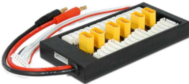
Parallel Ladeboard für bis zu 6 Lipo-akku Packs mit bis zu 6 Zellen, 6 Anschlüsse für je 2-6S Lipoakkus Packs XHR Balancersteckersystem, 6 Anschlüsse XT60 Stecker. Das Eingangskabel mit 2 Bananensteckern ist fest mit dem Board verbunden.
