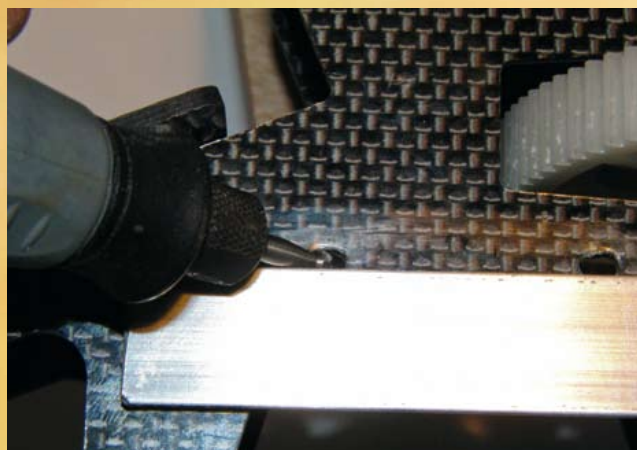
Um das korrekte Zahnflankenspiel einstellen zu können, mussten die Langlöcher mit einem Dremel in Richtung der Rotorwelle erweitert werden. Mithilfe eines Aluanschlages werden die Langlöcher schön gerade.
