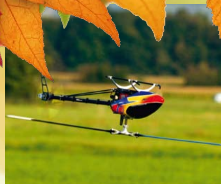
Mit 2.000 U/min am Rotorkopf zieht der Serienmotor einen Pitch von +/- 13° ohne hörbare Drehzahleinbrüche durch.
