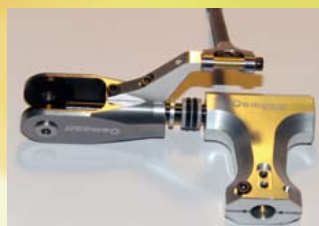
Die Blattlagerung ist recht hart. Auf einem Kunststoffring sitzen zwei O-Ringe zur Dämpfung. Ein zweiter Satz O-Ringe liegt im Baukasten bei.
