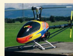
Die hochwertige, ansprechend lackierte Haube ist sehr stabil und bietet ausreichend Platz für zwei LiPos mit 6S und 3.300 mAh Kapazität.
