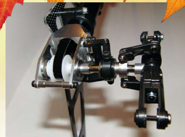
Die Heckmechanik ist nahezu spielfrei. Die Kugelpfannen der Blattanlenkung sollten ausgiebig geölt werden, bis sie leichtgängig sind.
