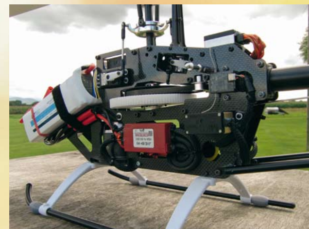
Das Chassis bietet im Inneren nicht viel Platz. Deshalb wurden alle Komponenten außen angeordnet. Wegen des besseren Governor-Mode wurde auf den Jive 80 HV umgerüstet.
