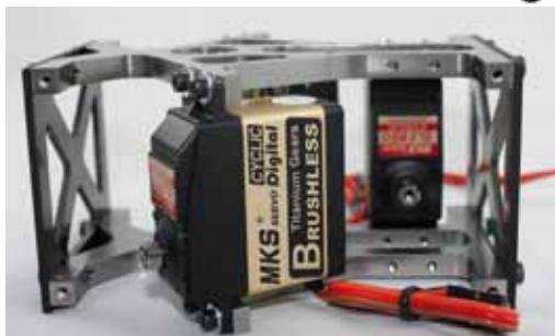
Servoeinbau im Detail. Die drei Taumelscheibenservos – hier sind die schnellen und starken MKS BLS 950 im Einsatz – werden an den höhenverstellbaren Lagerböcken der Hauptrotorwelle montiert. Das ermöglicht einen geraden und direkten Weg zur Taumelscheibe
