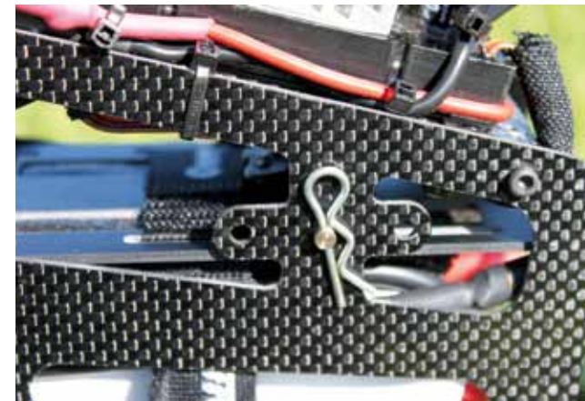
Saubere Lösung. Die Akkurutsche wird im Vorbau mittels eines Bolzens arretiert. Schwerpunktsänderungen sind durch mehrere Durchschub-Möglichkeiten möglich
