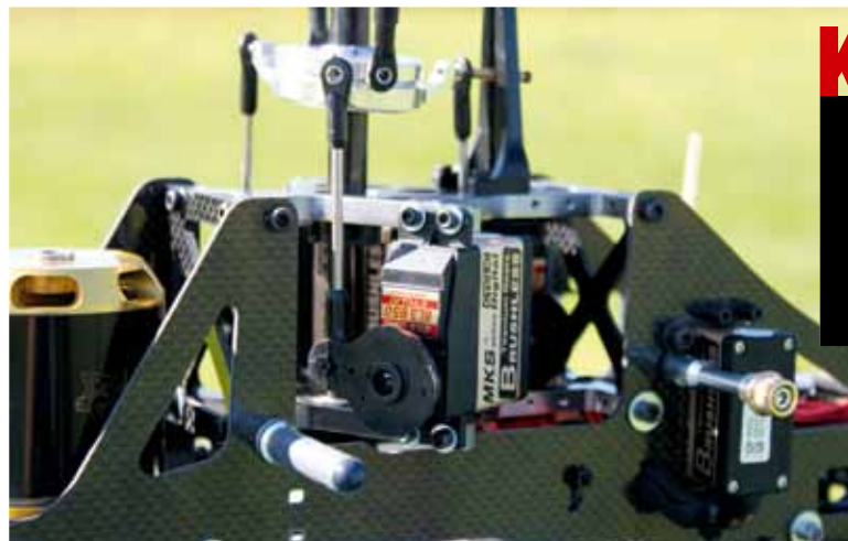
Die MKS BLS 950-Servos an der Taumelscheibe verrichten präzise und zuverlässig ihren Dienst. Die mitgelieferten Servoarme sind stabil und halten den Belastungen locker stand
