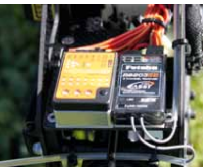
Auch hinter der Rotorwelle ist im 7HV reichlich Platz. Das eingesetzte Flybarless-System microbeast und der S-Bus-Empfänger passen locker nebeneinander
