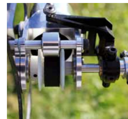
Die Andruckrolle sorgt für gute Riemenführung und verhindert ein Überspringen. Das Heckgestänge läuft oberhalb des Heckrohrs
