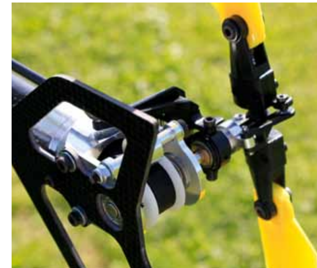
Der Heckrotorantrieb und die Anlenkung zeigen sich äußerst spielfrei. Leider waren die mitgelieferten Heckrotorblätter aus der Erstserie mit dem Drehmoment des Motors etwas überfordert
