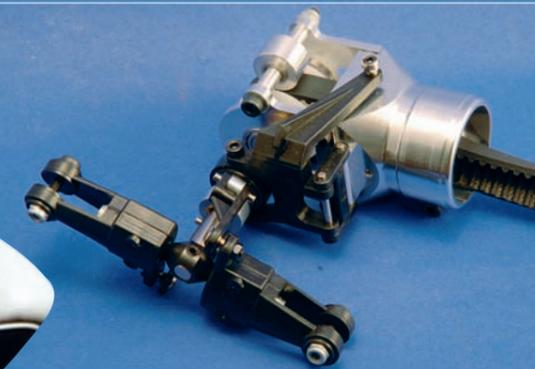
Die Heckrotoreinheit, wie sie dem Baukasten entspringt. Alles ist bereits fix und fertig montiert.
