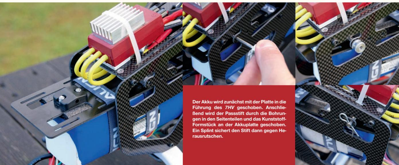
Der Akku wird zunächst mit der Platte in die Führung des 7HV geschoben. Anschließend wird der Passstift durch die Bohrungen in den Seitenteilen und das Kunststoff-Formstück an der Akkuplatte geschoben. Ein Splint sichert den Stift dann gegen Herausrutschen.
