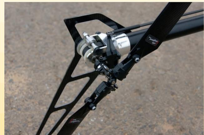
Der Heckrotor im Detail. Die Blatthalter wurden vom 3D plus übernommen. Die zusätzliche Andruckrolle verhindert ein Überspringen des Riemens bei starker Belastung.
