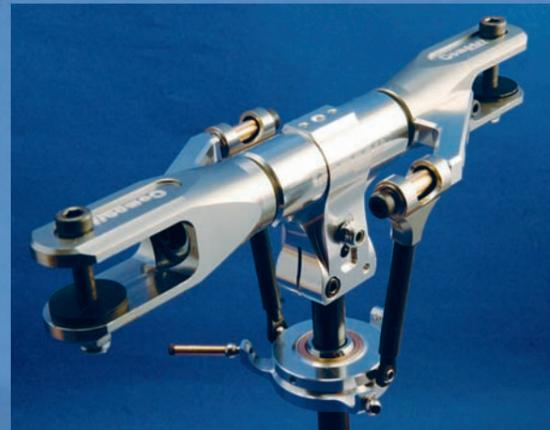
Die Konstruktion des Flybarless-Rotorkopfs hat sich bereits bei anderen Compass-Helis bewährt und wurde für den 7HV lediglich ein wenig großzügiger dimensioniert. Die Taumelscheibe stammt vom 3D plus bzw. 6HV.
