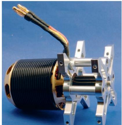
Die robuste Motorträgerereinheit mit Gegenlager versteift die Mechanik zusätzlich. Durch Langlöcher in den Seitenteilen kann sie komplett verschoben und so das Zahnflankenspiel eingestellt werden.
