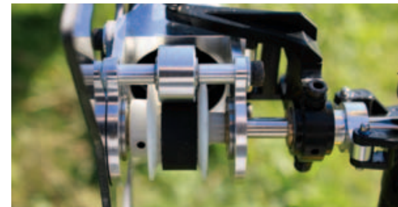
Andruckrollen verhindern ein Überspringen des Riemens bei hohen Belastungen
