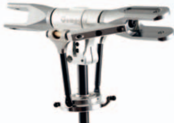
Ein Rotorkopf, wie er sein muss: Zentralstück, Blatthalter, Gestänge – Punkt
