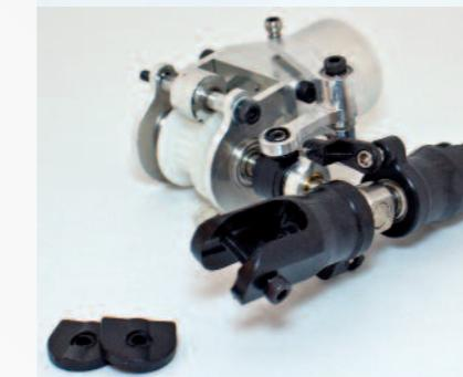
Der alte (oben) und der neue Heckrotor (unten) im Vergleich. Die Heckrotorwelle hat jetzt 6 mm und ist etwas kürzer, die Blattgriffe sind einteilig. Die Distanzplättchen werden nun formschlüssig eingesetzt, so dass die Blätter mehr Auflagefläche haben.
