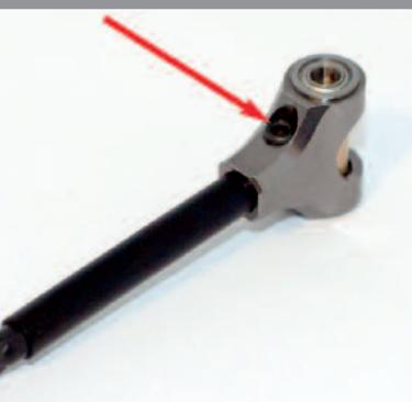
Eine Rotorbremse komplettiert ab sofort den Rotorkopf.
