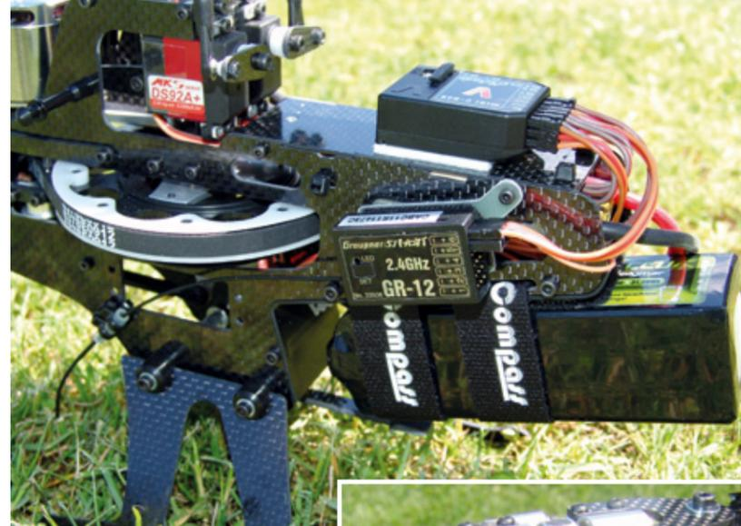
Der GR12-Empfänger versorgt das Mini V-Stabi per single line. Die Kanten der Carbon-Seitenteile sind abgerundet und partiell mit Tesa-Film abgeklebt. Über Kanal 5 laufen die Telemetrie-Daten des Controllers
