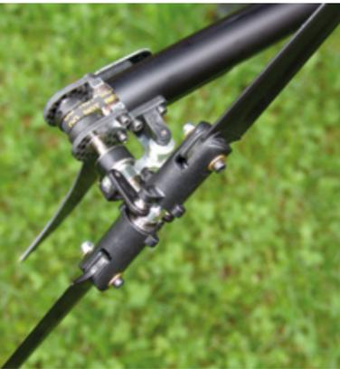
Der riemengetriebene Heckrotor muss sorgfältig aufgebaut werden, dann ist er leichtgängig und spielarm. Seine Performance ist auch mit den Standardblättern sehr gut
