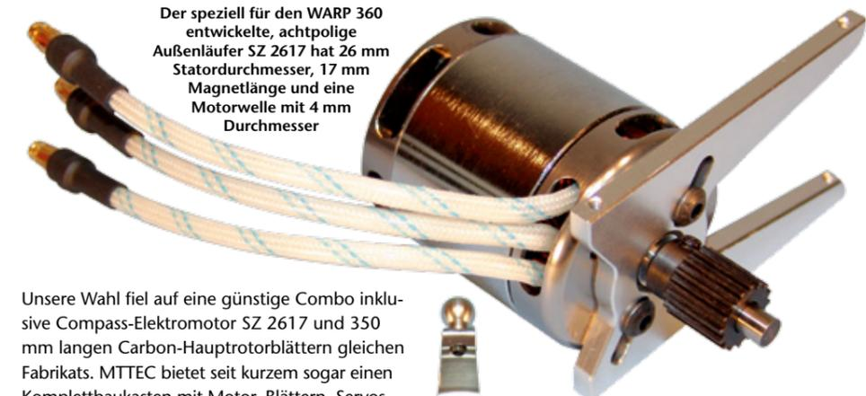
Der speziell für den WARP 360 entwickelte, achtpolige Außenläufer SZ 2617 hat 26 mm Stator Durchmesser, 17 mm Magnetlänge und eine Motorwelle mit 4 mm Durchmesser
