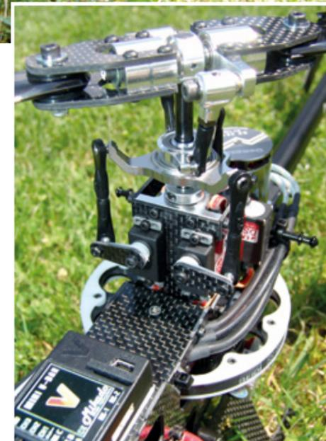
Das Zentralstück des Rotorkopf ist völlig ungedämpft. Die Blatthalter sind mehrteilig aus Carbon und Aluminium aufgebaut. Die Servohebel sind mit Carbon-Platten verstärkt und dadurch verwindungssteif
