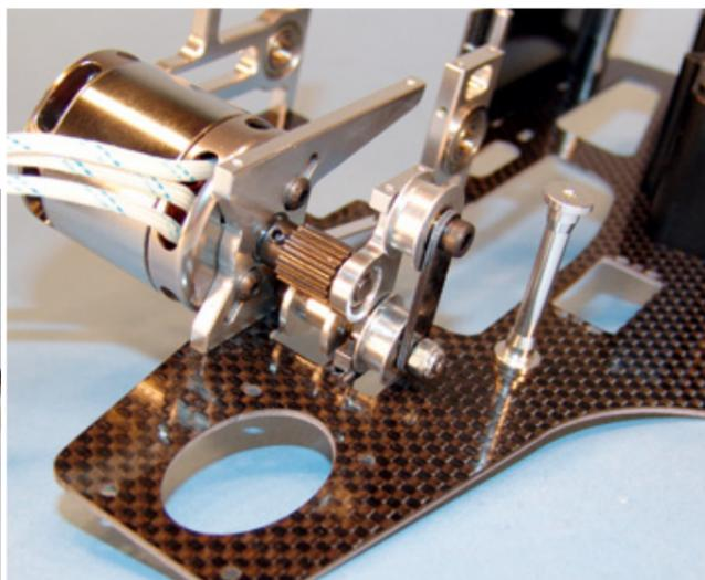
Das Gegenlager für die Motorwelle verhindert ein Ausweichen unter Last. Hinter dem Ritzel ist die zusätzliche Andruckrolle für den Haupt-Antriebsriemen erkennbar
