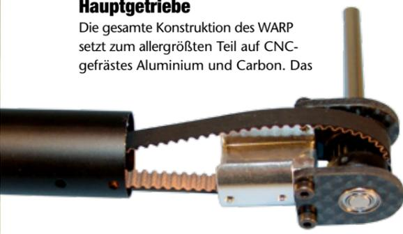
Die Aufnahme des Heckrotors wird in den Heckausleger eingeschoben und verschraubt. Das Riemenrad aus Kunststoff ist mit einem Spannstift befestigt
