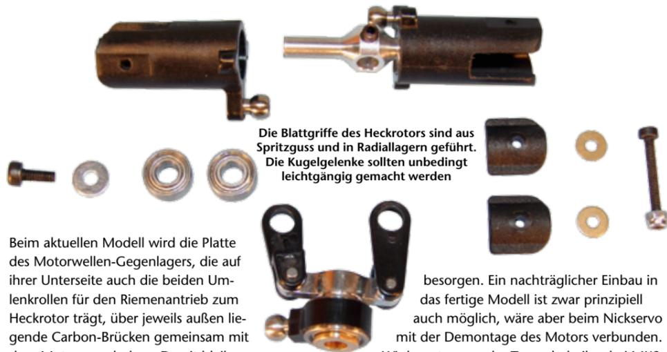
Die Blattgriffe des Heckrotors sind aus Spritzguss und in Radiallagern geführt. Die Kugelgelenke sollten unbedingt leichtgängig gemacht werden
