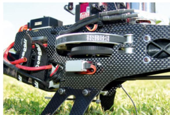
Das Mini-Heckrotorservo sitzt direkt unter dem Riemenrad. Der Heckabtrieb erfolgt ebenfalls mit einem Riemen und dreht in der Autorotation nicht mit
